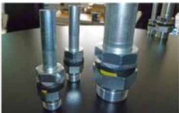
Stimmen die gelben Markierungen mit den Öffnungen des Indikatorkrings überein, ist die richtige Anzugsenergie erreicht.
