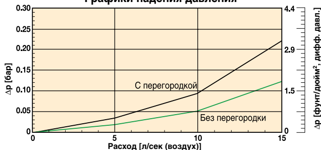
AV98XXX ввинчиваемый, без повышенного давления, Графики падения давления
