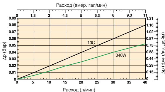
IN90 (Код длины элемента 3) Материал из целлюлозы и нержавеющей стали
