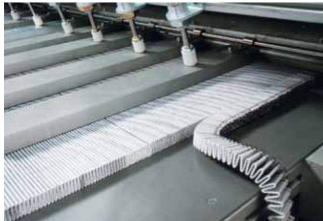
Процесс гофрирования фильтрующего материала
