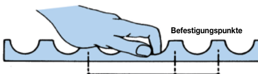
Bei dieser Bauform sind keine Bolzen und Muttern erforderlich.
